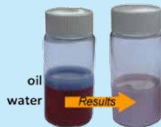
การนำตัวอย่าง สารอิมัลชัน (น้ำ-น้ำมัน) ผ่านเครื่อง High Pressure Homogenizer ทำให้สารถูกบด/ย่อยให้มีลักษณะเป็นเนื้อเดียวกัน
