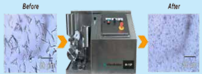
การนำตัวอย่างอนุภาคผ่านเครื่อง High Pressure Homogenizer
